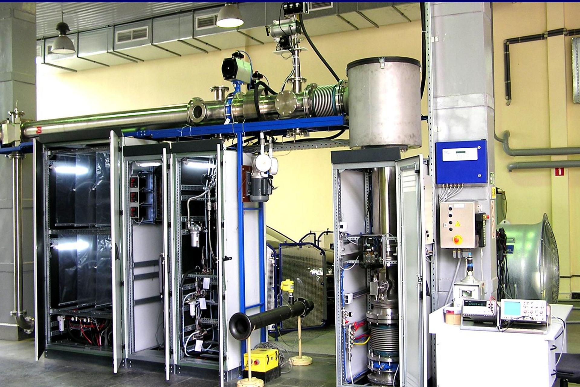
Перша в Україні система CVS для вимірювання масових викидів транспортних засобів, створена фахівцями ДП «ДержавтотрансНДпроект»
